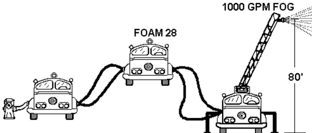
ALLOW 25 PSI LOSS FOR LADDER SYSTEM LOSS (LSL)\*\*\*
